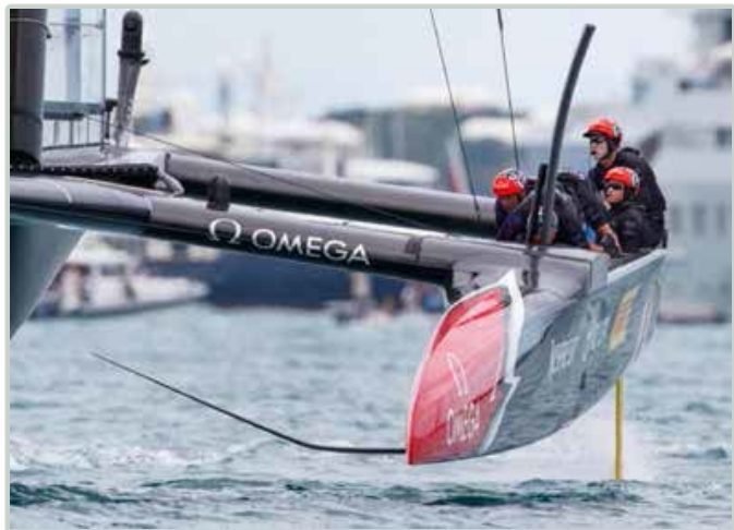
Катамаран с поднятым подводным крылом
